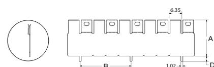
FIGURE Espacement picots 25.40mm. Avec épaulement. Avec trous
