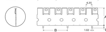
FIGURE Espacement picots 25.40mm. Pas d'épaulement. Avec trous
