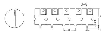
FIGURE Espacement picots 25.40mm. Pas d'épaulement. Avec trous
